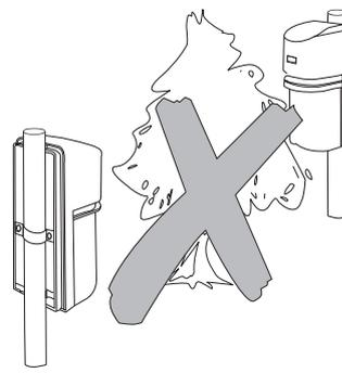
Non installare il rilevatore in un punto in cui si verifica un blocco a causa dell'ondeggiamento degli alberi causato dal vento o altri fattori.
